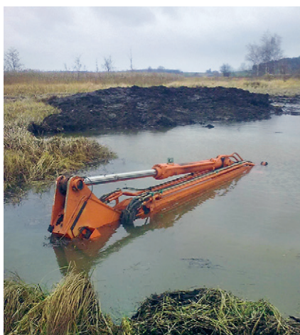
Mosejord kan være forræderisk at grave i, og Skenkelsø-projektet kostede entreprenøren en gravemaskine. Når først sådan en tonstung maskine begynder at synke, er der ikke meget at stille op. Fotos: Hedeselskabet.
