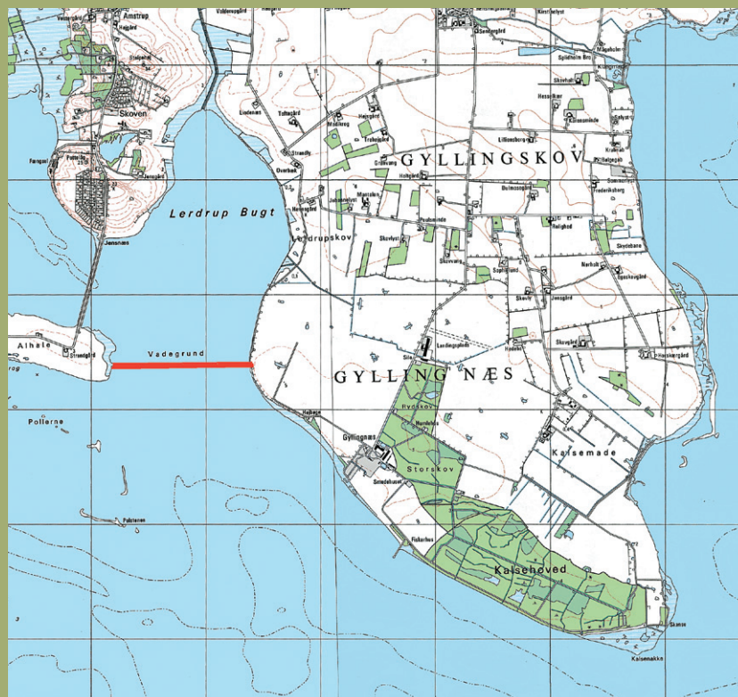
Alrø-dæmningen var blevet anlagt i 1931, så man behøvede blot en 1200 meter lang dæmning mellem Gyllingnæs og Alrøs østkyst for at kunne tørlægge 322 hektar fjordbund.
